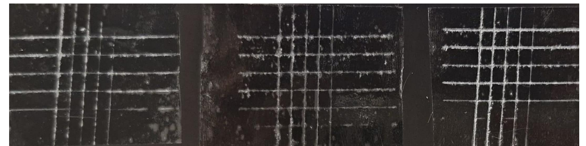
Şekil 3. Çapraz tarama testi
